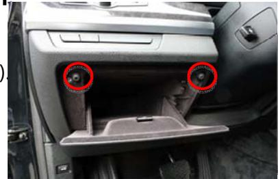
2. Untere Kunststoffabdeckung durch lösen zwei weiterer Schrauben demontieren.
