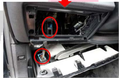
3. Lichtleiterstecker vom Gateway Modul entfernen und mit der Lichtleiterbuchse am Kabelsatz verbinden.
